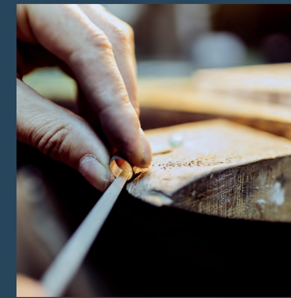
Ein Goldschmied beim Feilen der Innenseite eines Ringes mit einer speziellen Juwelierfeile
